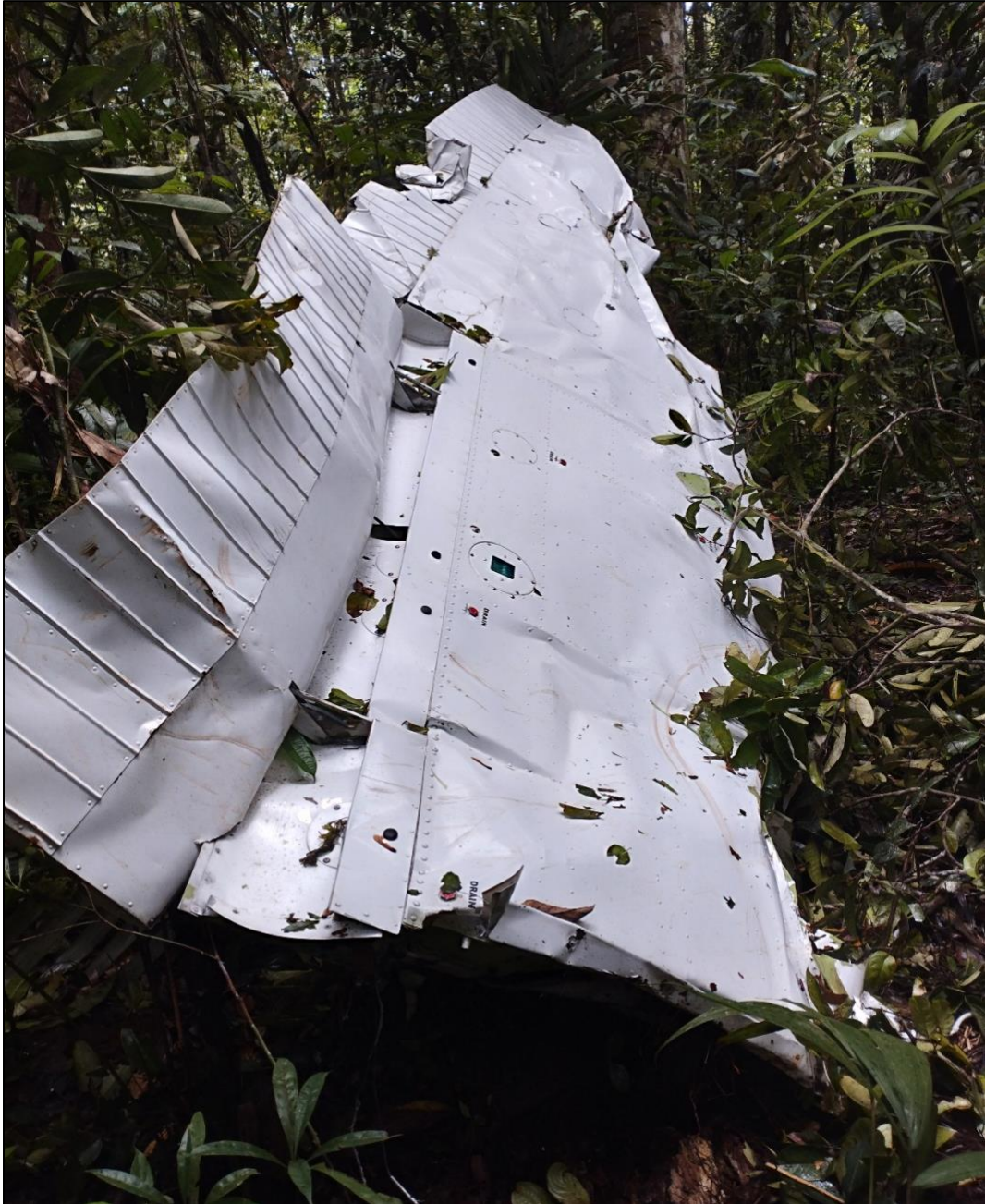
Fotografía No. 3 - Plano derecho de la aeronave fracturado.
