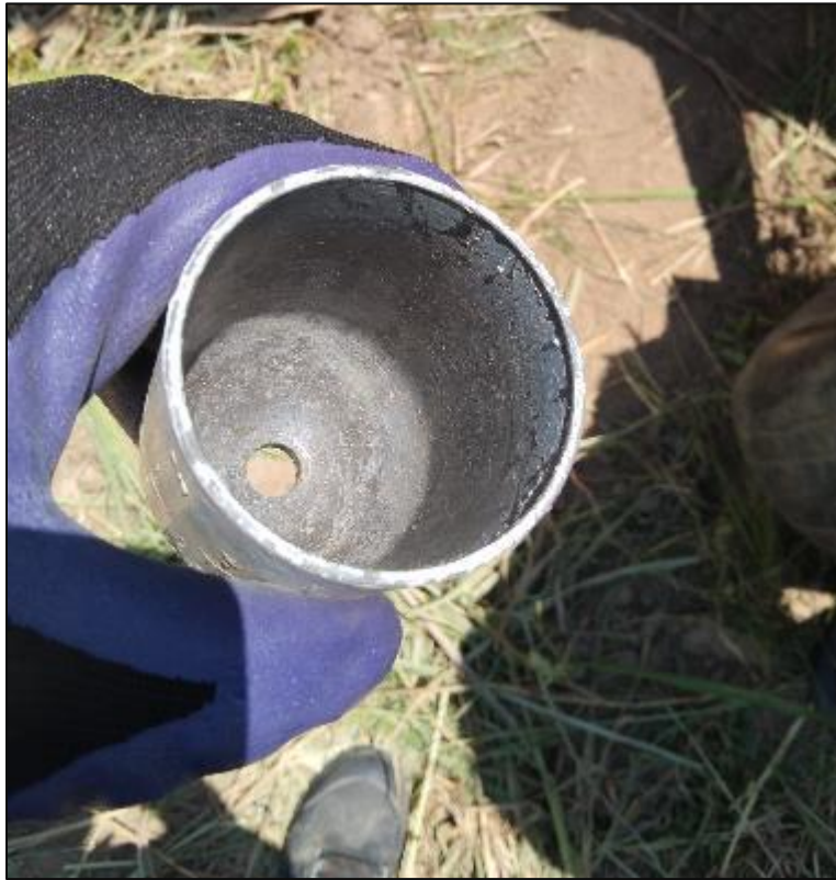
Figura 7: Vaso filtro del sistema de combustible.
