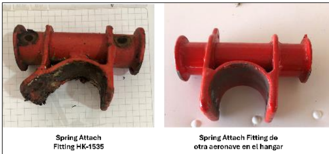
Figura 9: Comparativo de piezas de acople de patines de cola.
