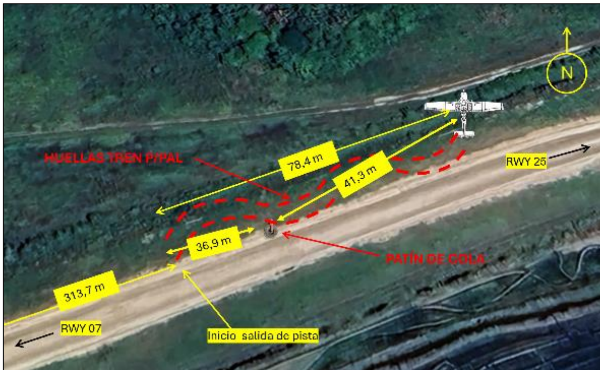
Figura 2: Posición final de la aeronave HK-1535.
