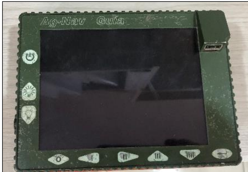
Figura 10: sistema GPS AGNAV recuperado del HK-1535.
