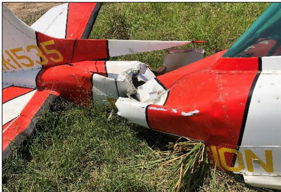
Figura 18: Fractura en la parte posterior del fuselaje.
