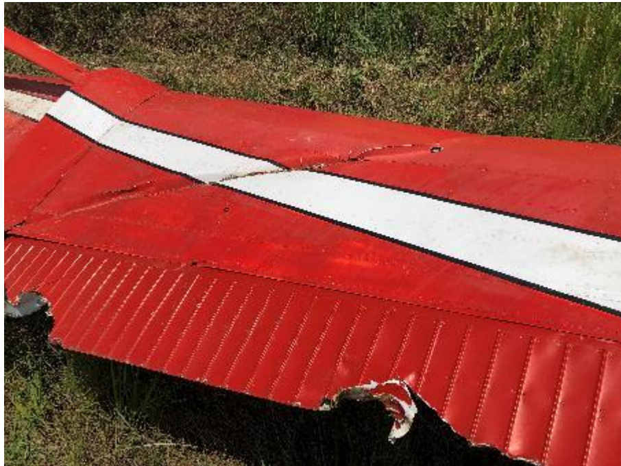
Figura 16: deformaciones en el plano derecho.
