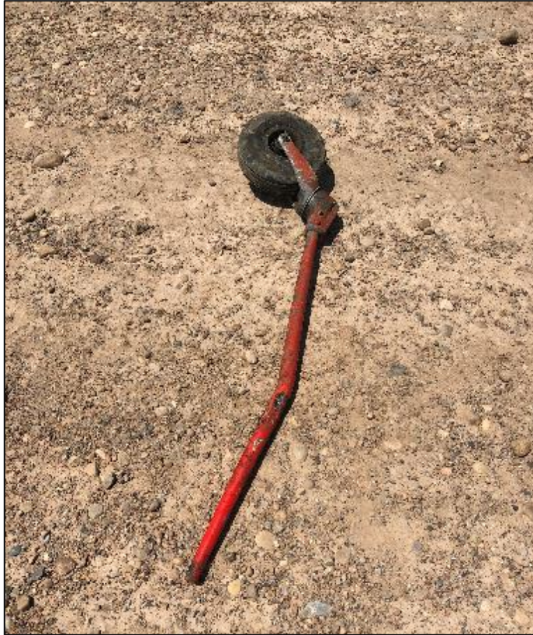
Figura 6: Patín de cola desprendido (luego de ser retirado de su posición final).
