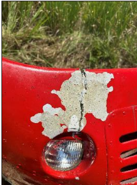
Figura 19: Capot del motor con fractura sobre la luz de aterrizaje derecha.
