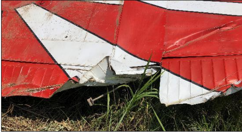
Figura 17: deformaciones en el flap derecho.
