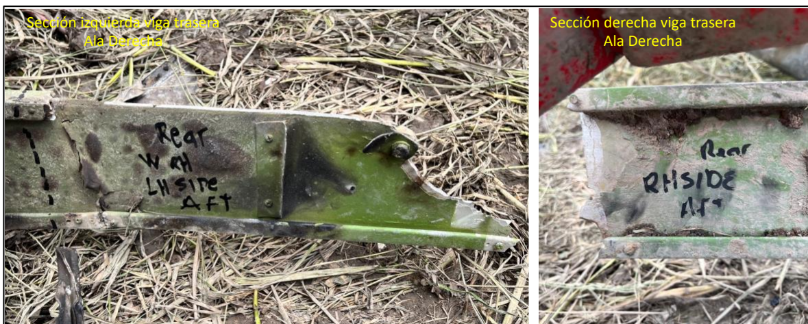
Fotografía No. 5 – Condición final de viga trasera del ala derecha HK1207
