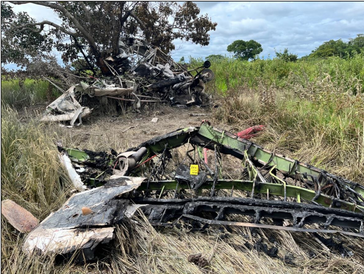
Fotografía No. 3 – Estructura del plano derecho invertido – HK1207.
