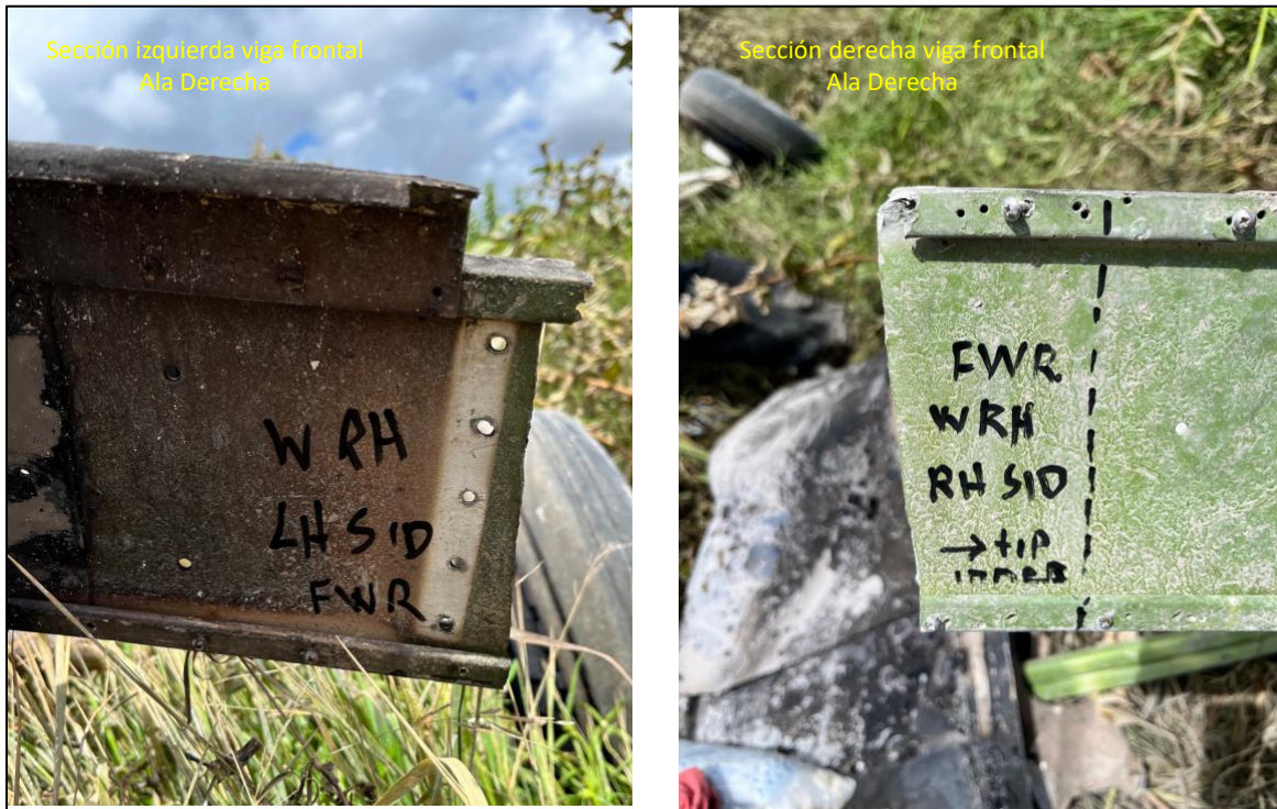
Fotografía No. 4 – Condición final de viga delantera del ala derecha HK1207
