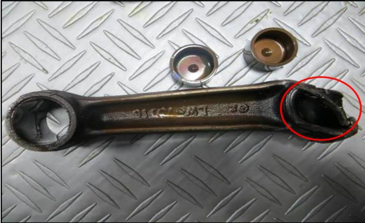
Fotografía No. 15: Fractura frágil biela No.3.
