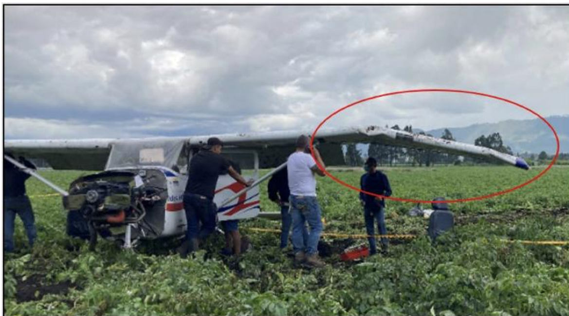
Fotografía No. 4: Daños sustanciales plano izquierdo.
