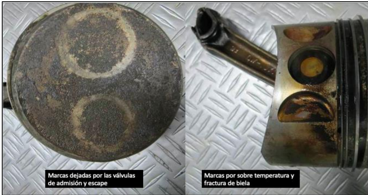
Fotografía No. 12: Marcas dejadas por las válvulas en la cabeza del pisto.
