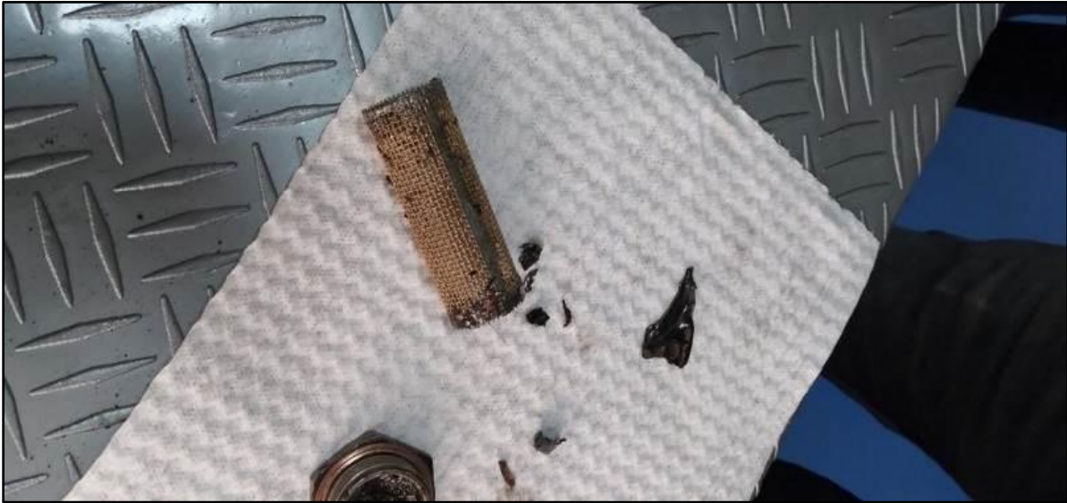
Fotografía No. 8: Filtro de aceite del motor con presencia de limallas.
