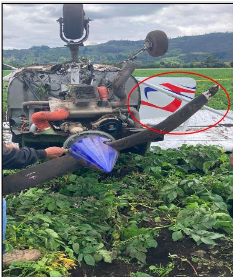
Fotografía No. 2: Daños sufridos por el motor y hélice.
