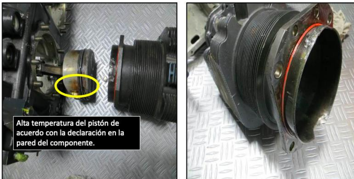
Fotografía No. 11: Daños en cilindro y pistón por sobre temperatura.
