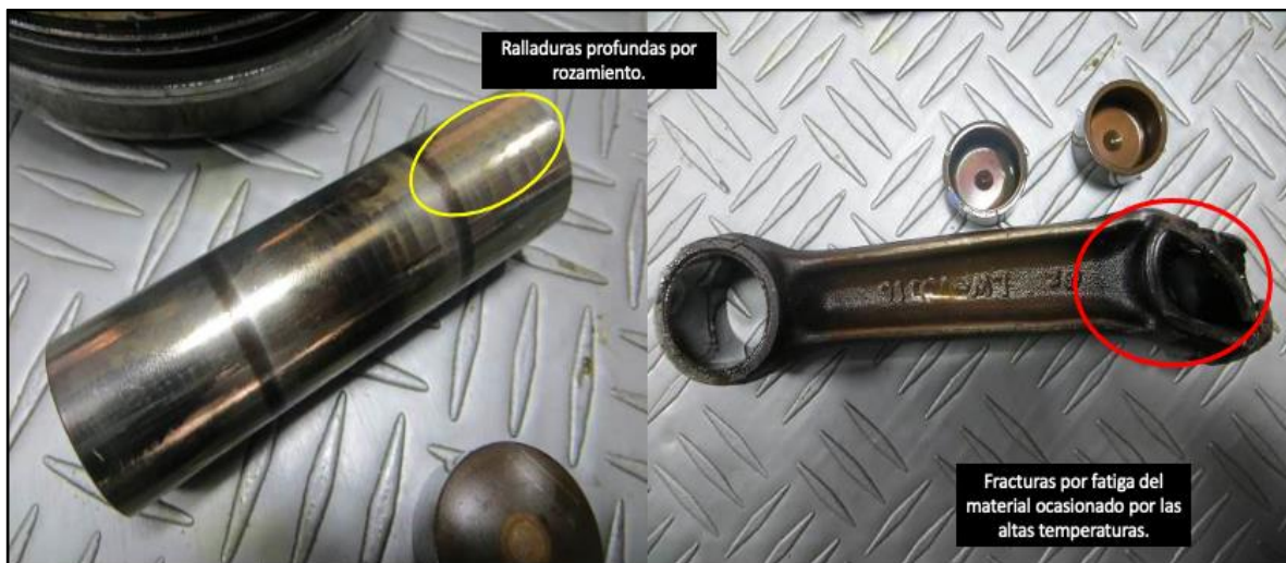
Fotografía No. 13: Marcas dejadas por rozamiento y alta temperatura.
