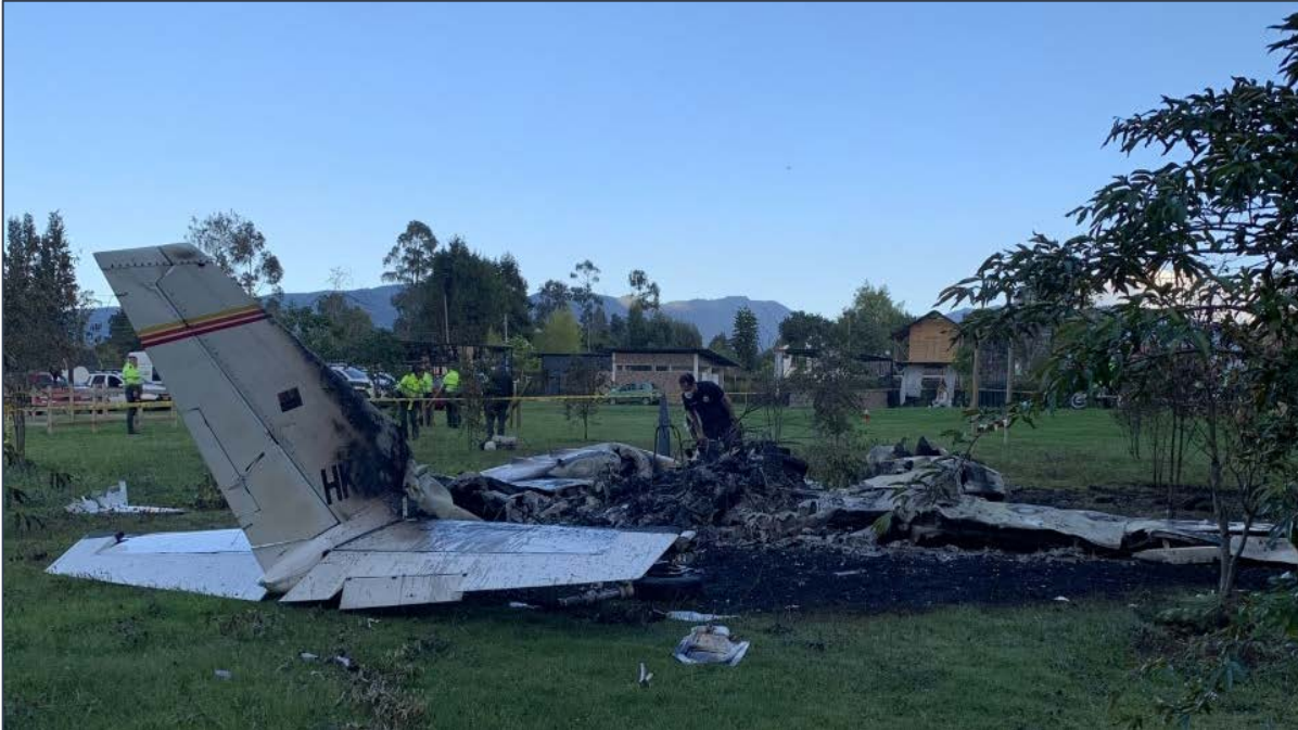
Fotografía No. 3 - Afectación a la aeronave por el incendio post impacto
