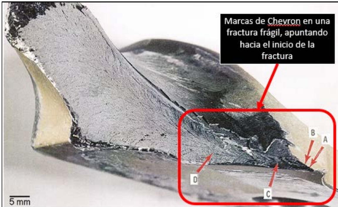
Fotografía No. 9 - Fractura frágil en cilindro 6 con marcas tipo "chevron".
