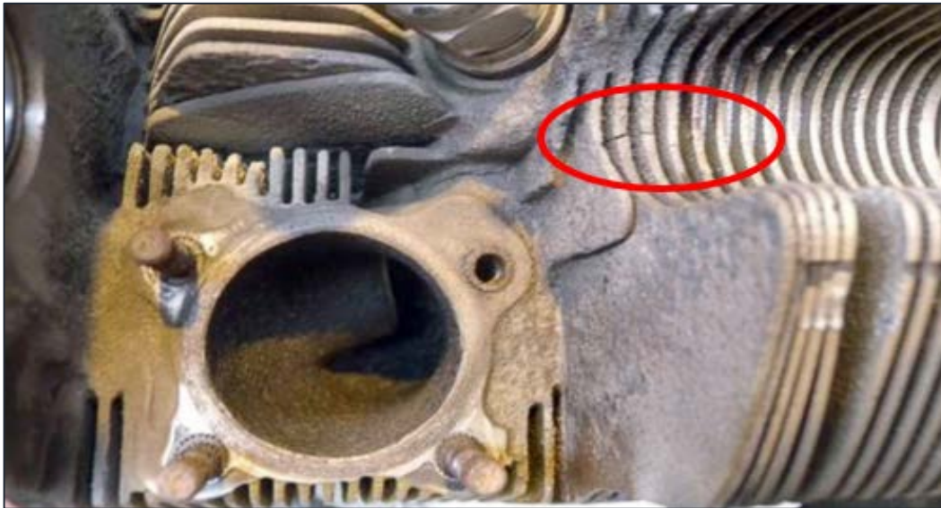
Fotografía No. 6 – Fractura encontrada en el cilindro No. 2
