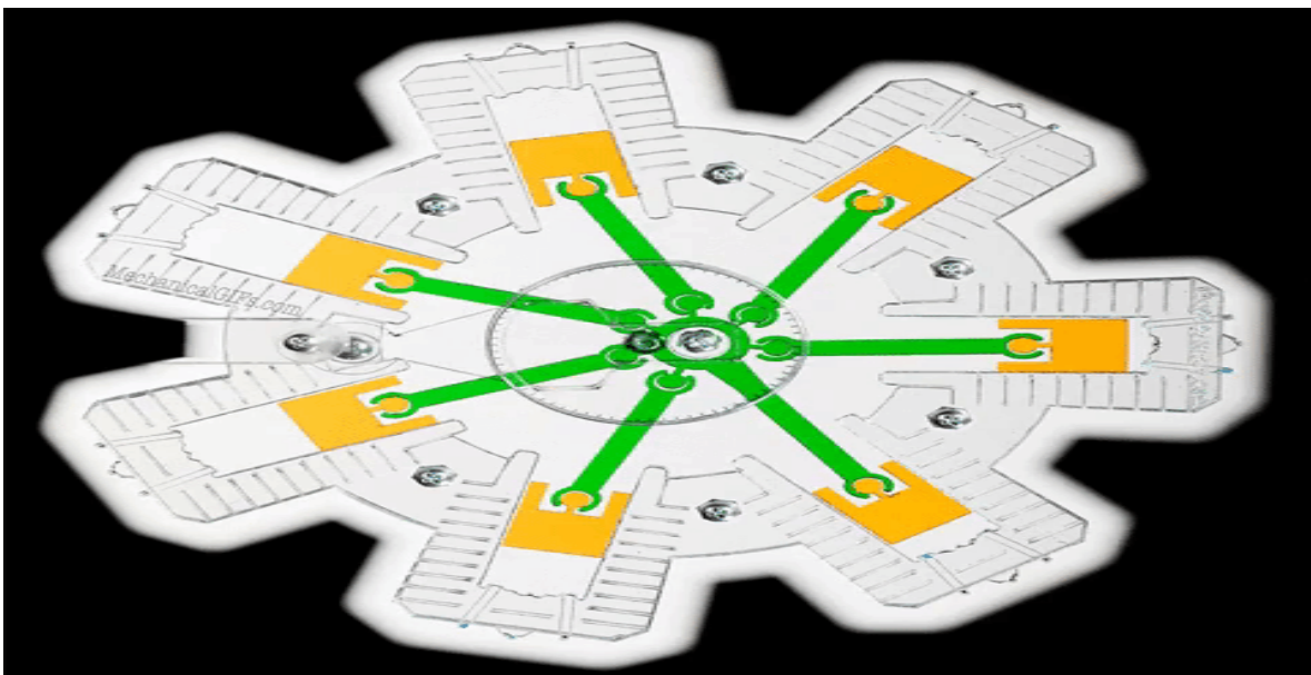
Figura No. 12: Funcionamiento interno de un motor radial.
