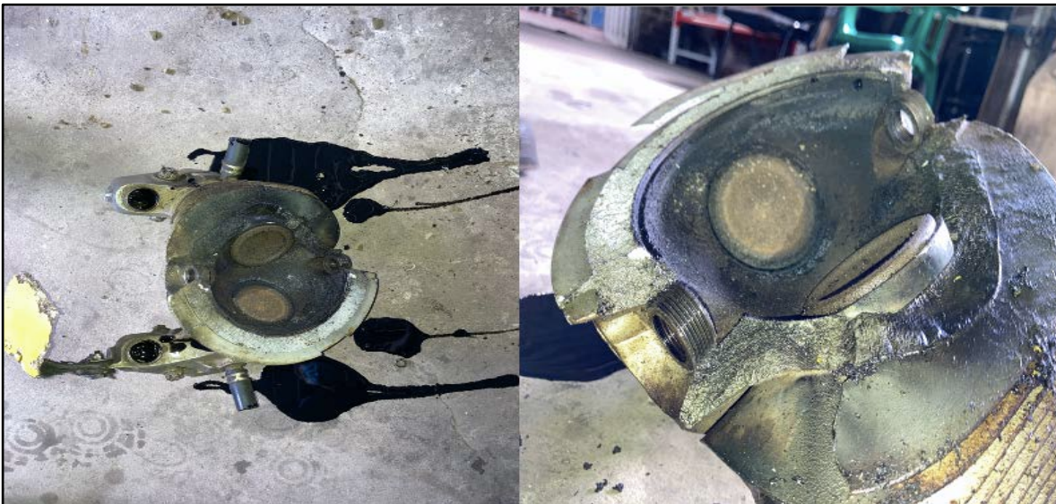
Fotografía No. 9: Fractura total del cilindro No. 7.
