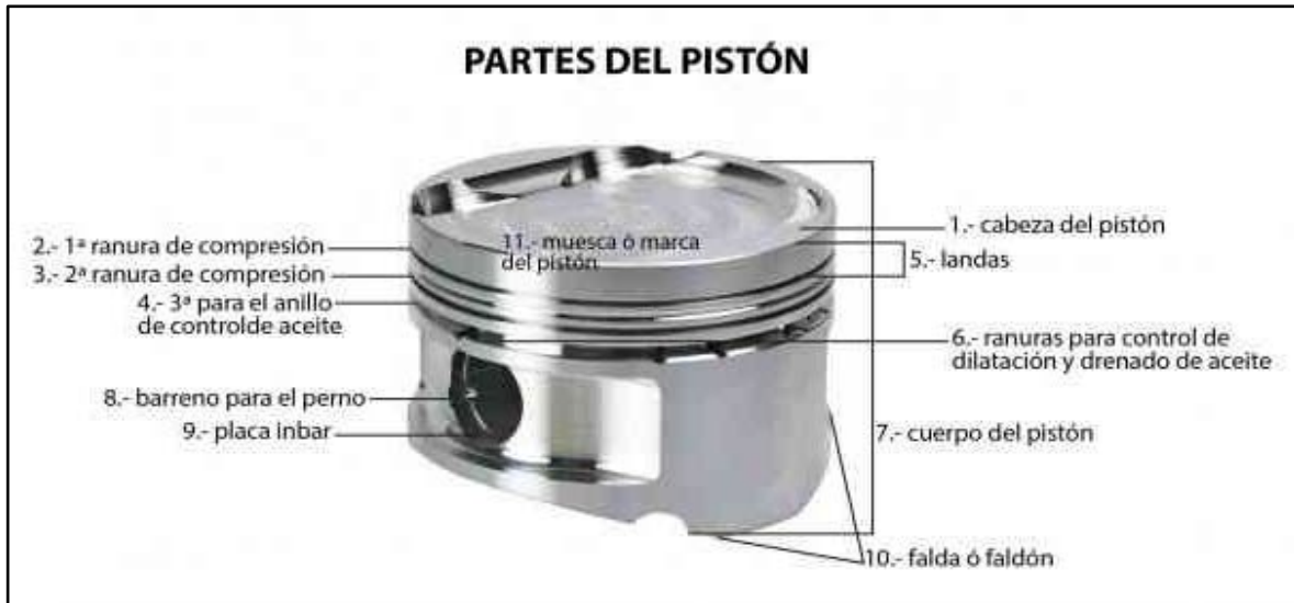
Figura No. 10: Partes de un pistón.
