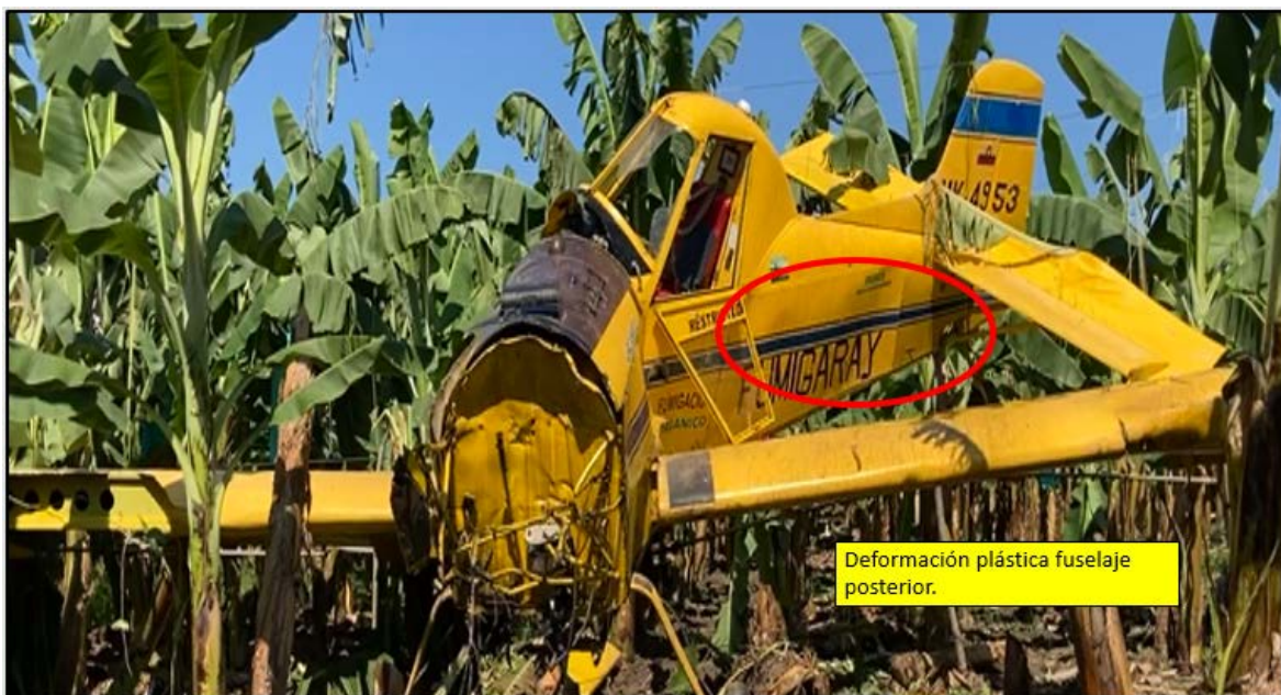
Fotografía No. 5: Daños en el fuselaje lateral izquierdo.
