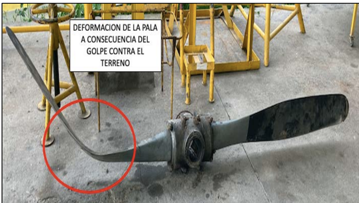
Fotografía No. 3: Daños en la Hélice.
