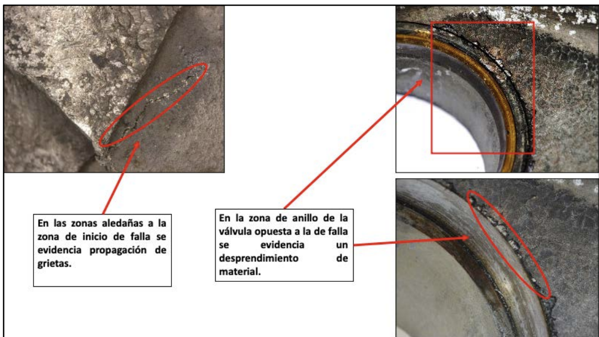
Fotografía No. 17: Zona propagación de grietas.
