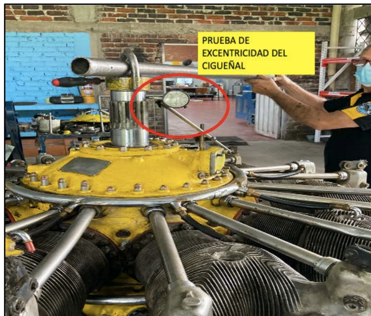
Fotografía No. 7: Prueba de excentricidad al cigüeñal.
