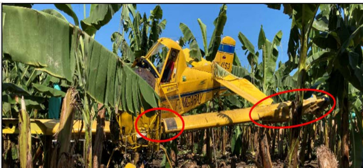
Fotografía No. 6: Desprendimiento del plano izquierdo y múltiples golpes en el borde de ataque
