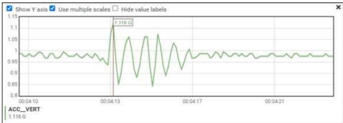
Figura No. 1– Valores de aceleración vertical durante el evento.
