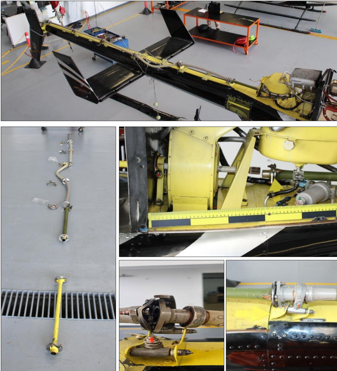
Imagen No. 7: Sistema de ejes impulsores del rotor de cola y los diferentes daños causados.
