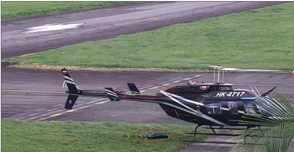
Imagen No. 2. Evidencia de la separación de la cubierta del tail boom y daños eje impulsores rotor de cola.
