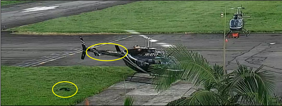
Imagen No. 3: Posición final de la aeronave y de la cubierta del tail boom.
