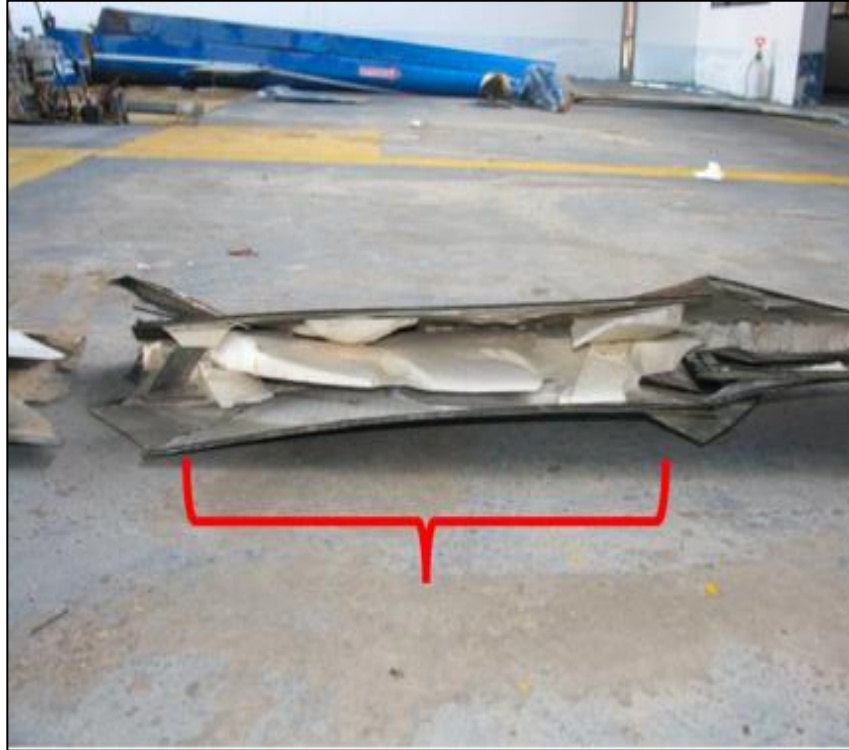
Fotografía No. 9 - Borde de salida de la pala del rotor principal que se desprendió por el impacto.
