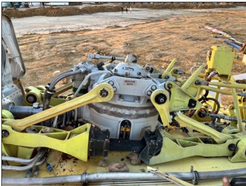
Fotografía No. 5 – Condición final de la transmisión helicóptero HK5268.
