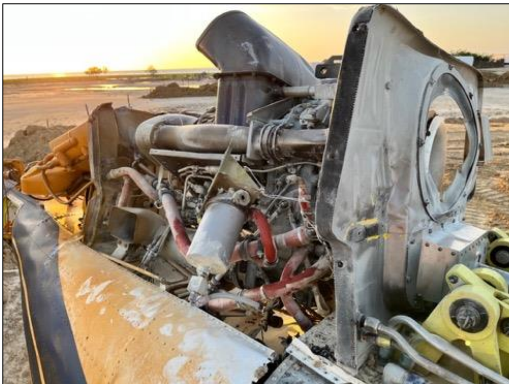
Fotografía No. 4 – Condición final del motor helicóptero HK5268.
