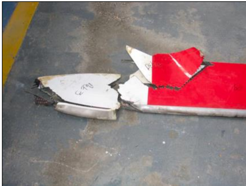
Fotografía No. 10 - Punta roja de la pala separada de acuerdo con las fuerzas de impacto contra el terreno
