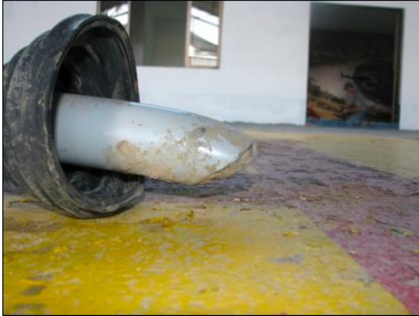
Fotografía No. 12 - Fractura del mástil debido a las fuerzas de impacto
