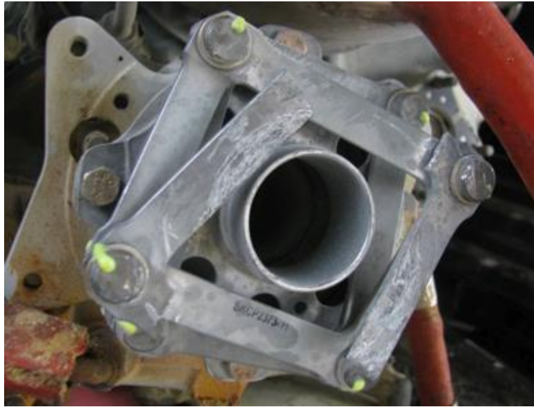
Fotografía No. 14 - Daño en el extremo del acoplamiento del eje de transmisión principal Kaflex.
