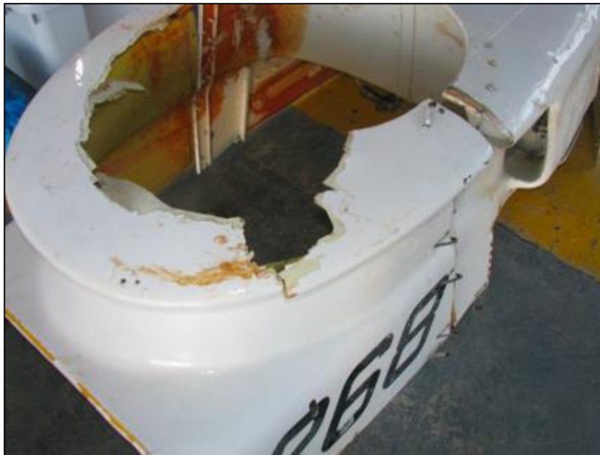
Fotografía No. 13 - Daños en la cubierta de la transmisión.
