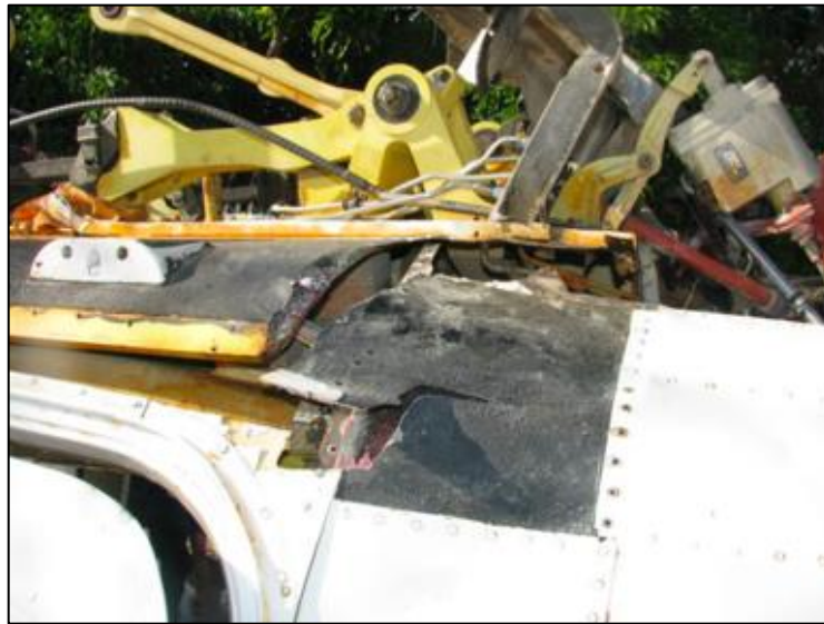
Fotografía No. 7 - Fractura de la sección estructural superior del techo trasera izquierda
