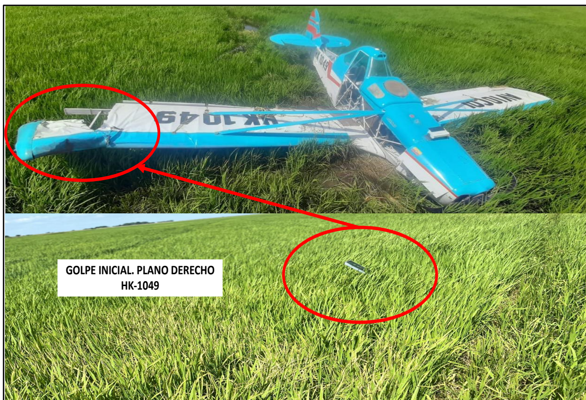
Fotografía No. 5: Impacto del plano derecho de la aeronave con el poste caído.
