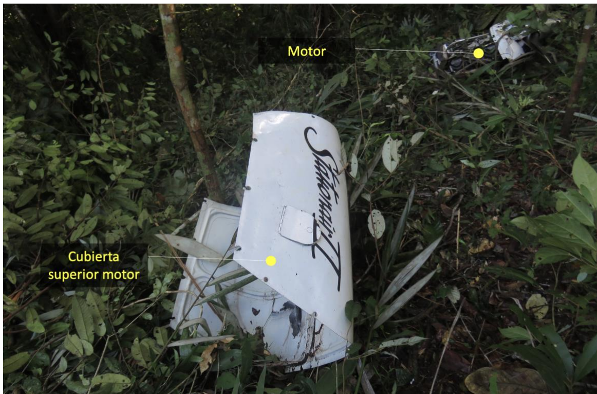
Fotografía No. 3 – Ubicación y condición final del motor y su cubierta superior
