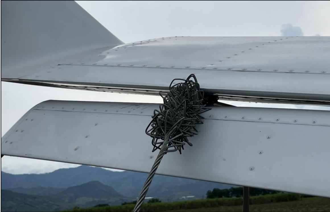
Fotografía No. 2: Cuerda enredada en el plano izquierdo del HK5346.
